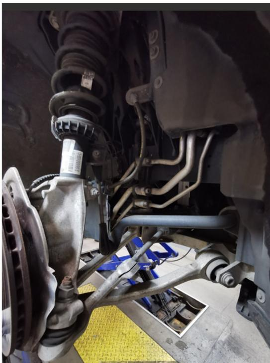
Hinterradaufhängung: 5-Lenker (einlagige Stahlblechlenker, schweißfrei), Alu Radträger:
