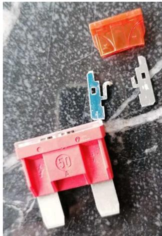
und die kommt rein: 10 A mehr und als Maxifuse doch etwas robuster. Da ich es für nervig halte zum Sicherungswechsel immer den Akku zu zerlegen, kommt ein Halter rein, der erlaubt, die Sicherung von außen zu ersetzen:
