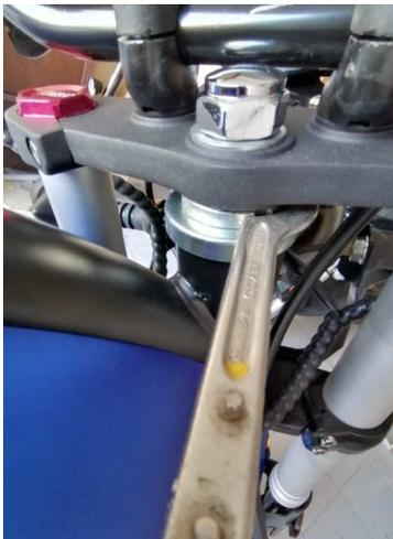
dabei die Gabelbrücke beidseits von den Standrohren lösen und nachrutschen! Dann oben die verchromte (Konter)Mutter nachziehen. Reifen aufpumpen: 2,2 Bar.
