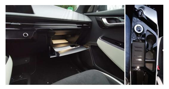
Handy-Ladeschale prominent auf der Mittelkonsole. Die "Touch-Schalter" am vorderen Ende der Konsole etwas versteckt und leider ohne haptischen Druckpunkt. Die Handbremse wie bei Mercedes-selig vorn links unter der Armaturentafel. Naja... Zwischen den Füßen von Fahrer- und Beifahrer\*in ist eine große Ablagewanne, in die auch die großen "Hand"taschen passen, wie sie meine Frau immer rum schleppt, ohne in die Füße zu rutschen.
