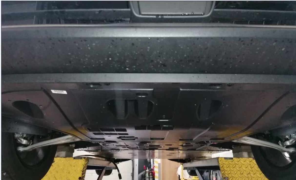
Aluminium Schwenklager und Querlenker an der Vorderachse (leicht aber teuer):
