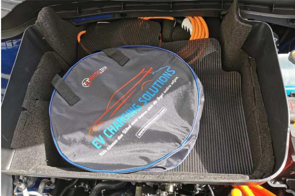
Apropos: das Teutschtech Spiralkabel ist für den Nasenlader perfekt. Als 16A (11 kW)-Ausführung zudem noch leicht und handlich. Die schweren 32A-(22kW)Kabel sind unnötig. Und hängen zuviel durch.
