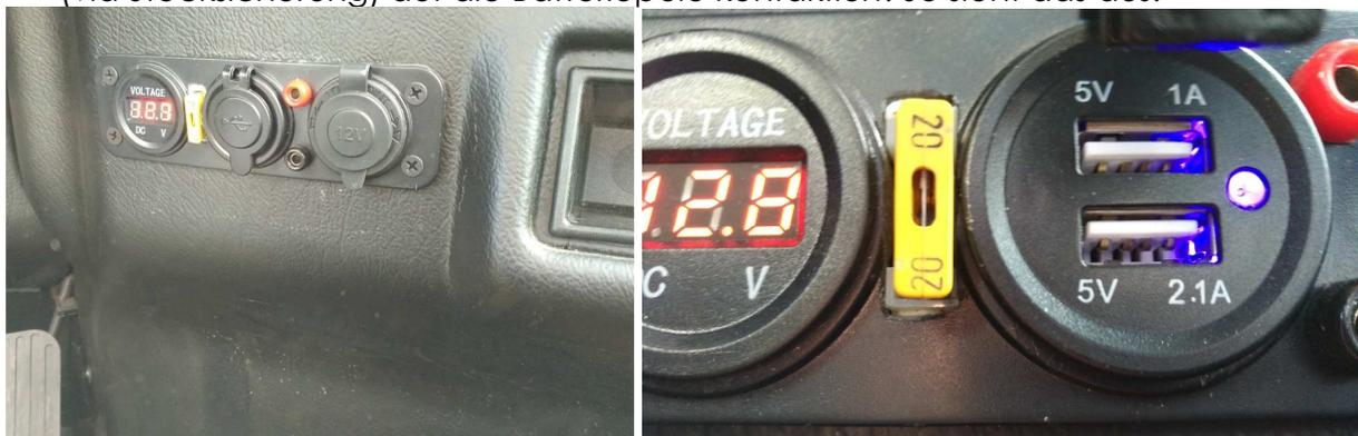
Über die Bananenbuchsen kann man via Sicherung direkt die 12V Batterie kontaktieren, also auch laden. Am Display sieht man, wie voll die noch ist. Zieht man die Sicherung, ist das kpl von der Batterie getrennt.
