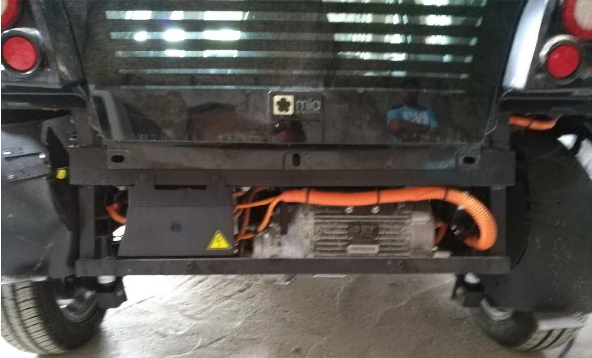
Controller/Inverter (links neben dem Motor):
