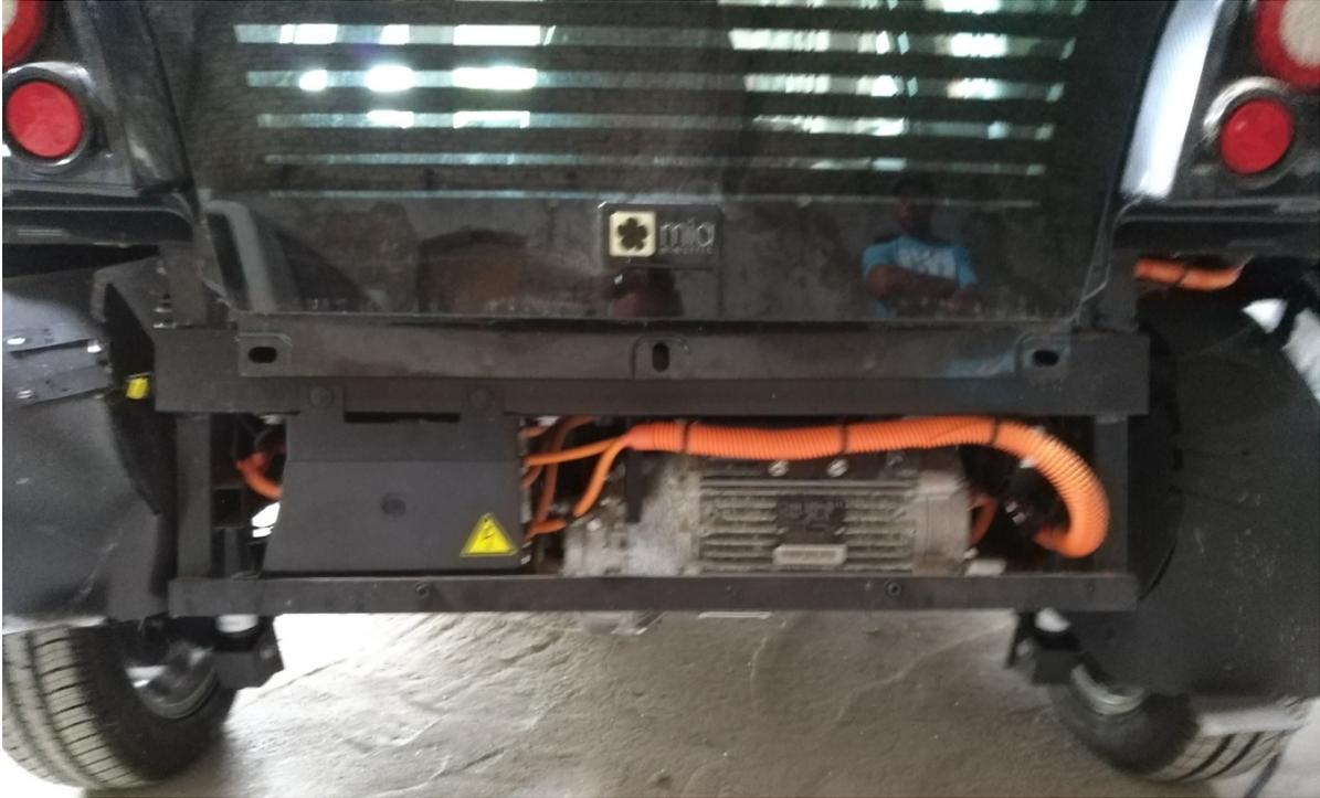
Controller/Inverter (links neben dem Motor):
