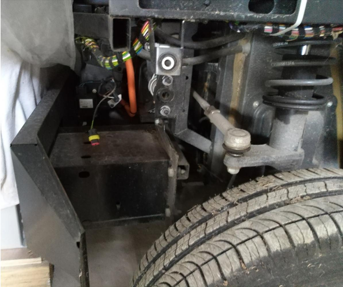
Hinterachse: gezogene Längslenker:
