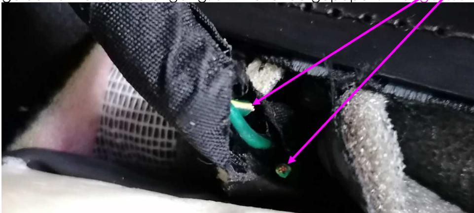
Das passiert, weil der zu kurze Kabelbaum der zu groben „Litzen“kabel beim Sitzlehnen-Umklappen gezogen und gebogen wird, was er halt nur ein paar Mal aushält. Scheiß Ami-Qualität! Mit hochwertigen Litzenkabeln alle 3 Kabel verlängert (natürlich gelötet und mit ordentlichem Schrumpfschlauch isoliert), wieder alles zusammengepopelt -> Lampe aus, alles in Butter. Hätte man auch gleich richtig machen können – so 3 Zentimeter mehr und der Kunde hätte keinen Ausfall! ☺
