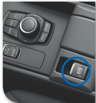
**2** Schalter für elektronische Parkbremse nach oben ziehen.
